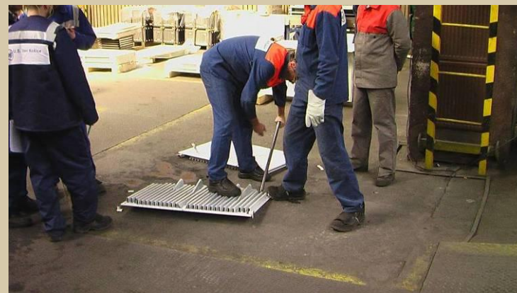
Kontrola kvality privarenia konvektorov
